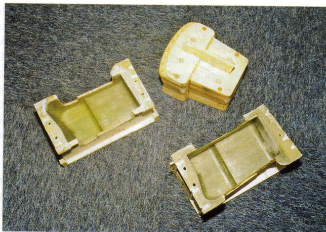
Beide Halbschalen sind von der Positivform abgelöst; gut zu erkennen die Löcher, durch die sich die beiden Formen passgenau verbinden lassen
