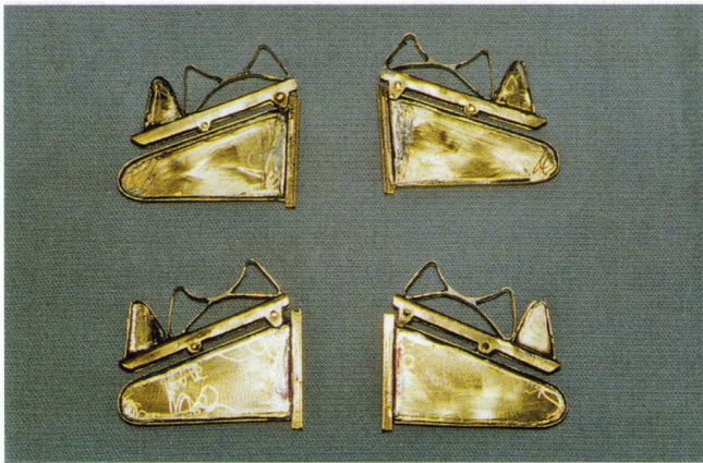
Die Seitenteile der Abwurfseinheiten sind komplett gelötet
