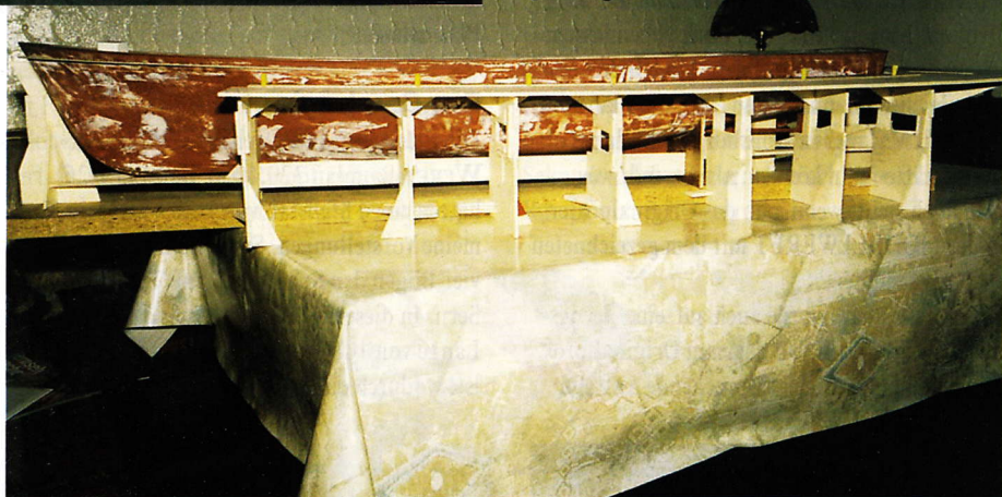
Provisorische Vorrichtung zum Fräsen und Einkleben der Scheuerleisten aus 1,5-mm-Sperrholz.
